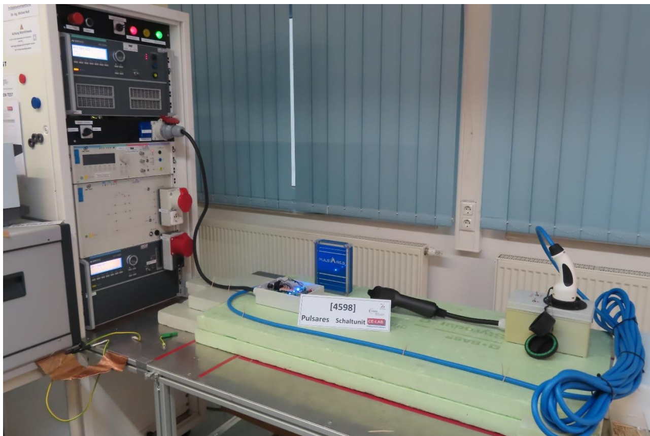
Foto 17: Prüfaufbau, EN 61000-4-11 (DIPS) SV AC-Eingang Tabelle 4 EN 61000-6-2
