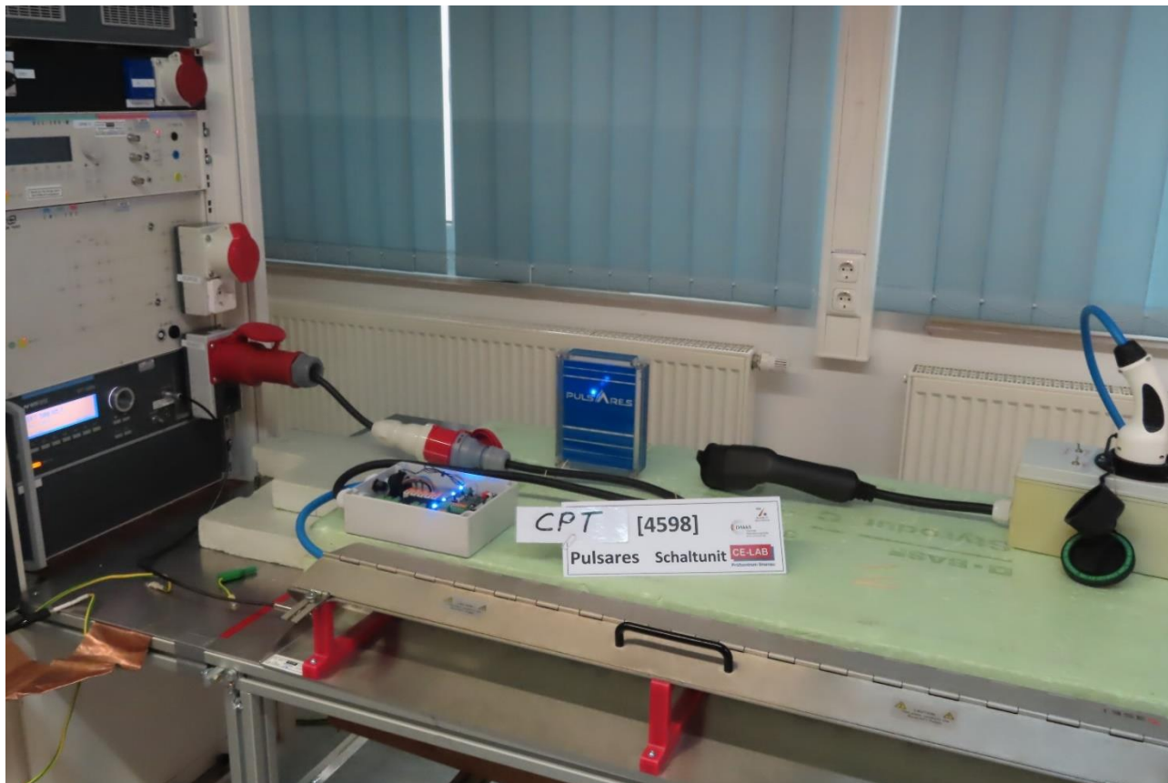
Foto 13: Prüfaufbau Störfestigkeit, EN 61000-4-4 (BURST) CPT, Tabelle 1 IEC 61851-21-2
