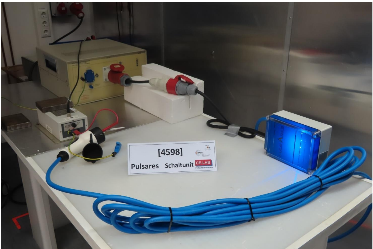
Foto 4: Prüfaufbau Störspannungsmessung- CPT Port
