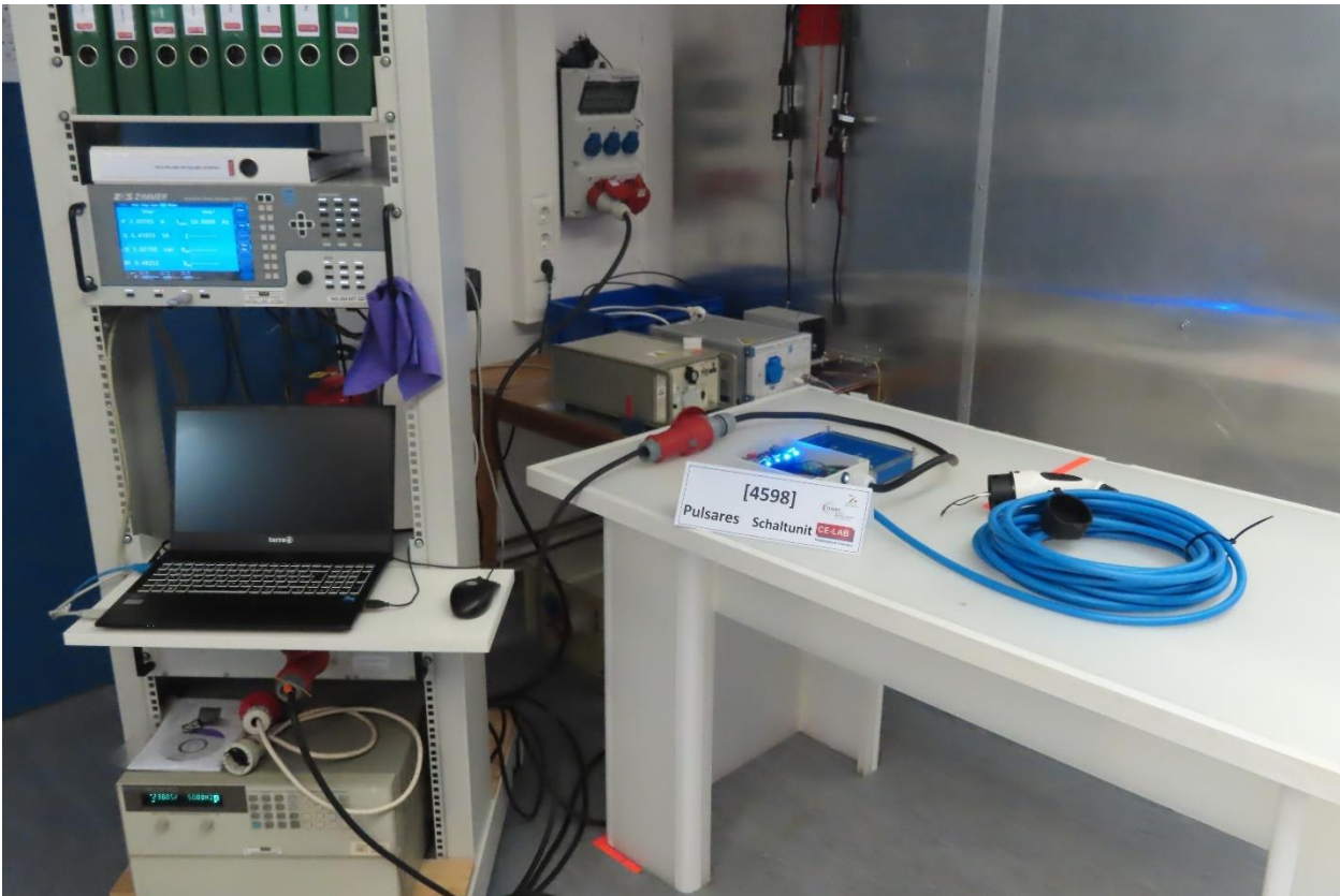
Foto 6: Messplatz für Oberschwingungen und Spannungsschwankungen
